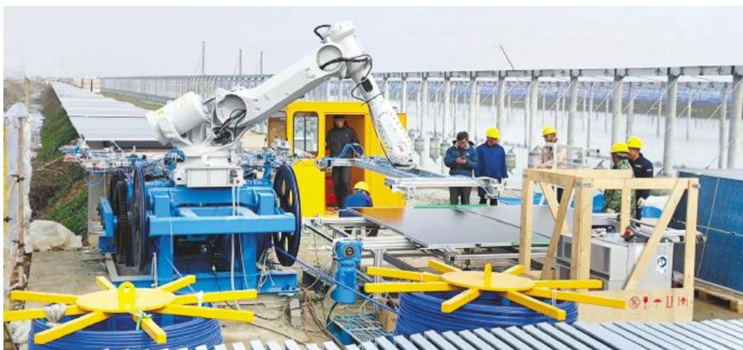
组件自动化安装设备野外测试
